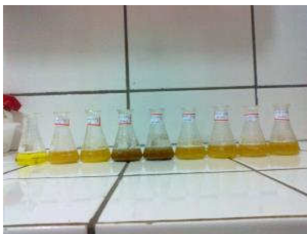
Figura 3. Mistura do corante vermelho de fenol 10 \text{ mg.L}^{-1} após o processo de biossorção.
