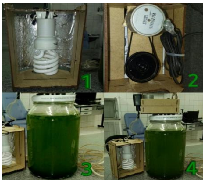
Fotografia 2- 1-Iluminação, 2-Mecanismo de agitação, 3-Pote(tanque), 4- Fotobiorreator. Fonte: Autores.
