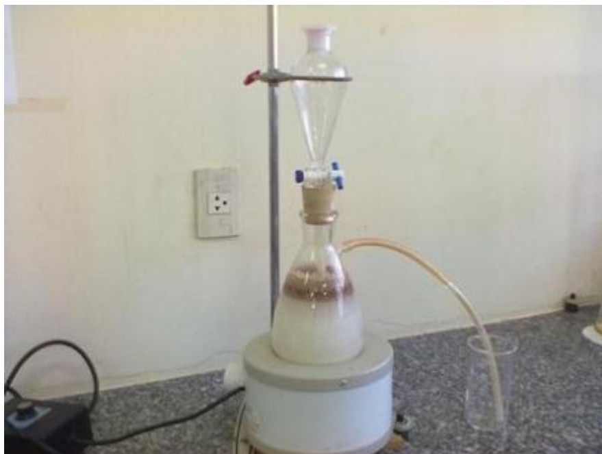
Figura 1 Montagem do sistema de extração de óleos vegetais pelo método Marziel
