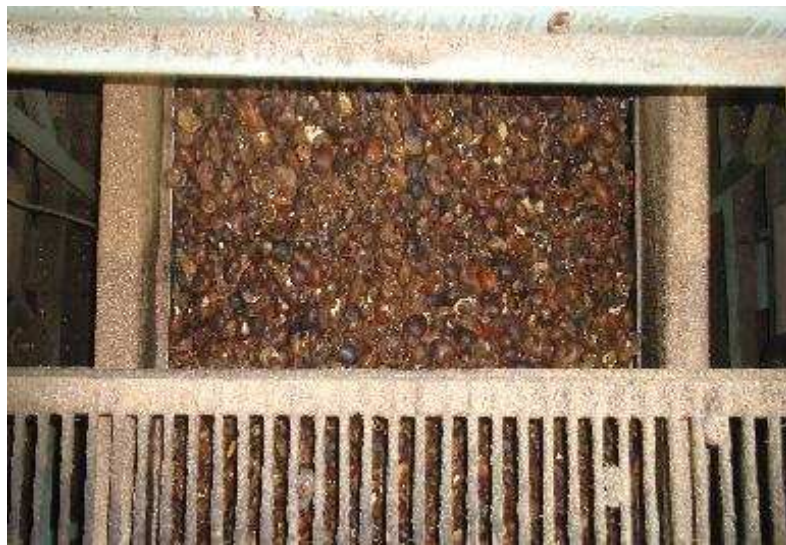
Figura 2 - Castanhas em excesso na máquina de peneiras vibratórias
