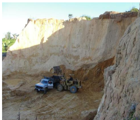
Figura 5- Caminhão sendo carregado na de extração de massará nos paleoterraços fluviais, na Alegria no bairro Planalto Bela Vista. Fonte: Viana (2010)
