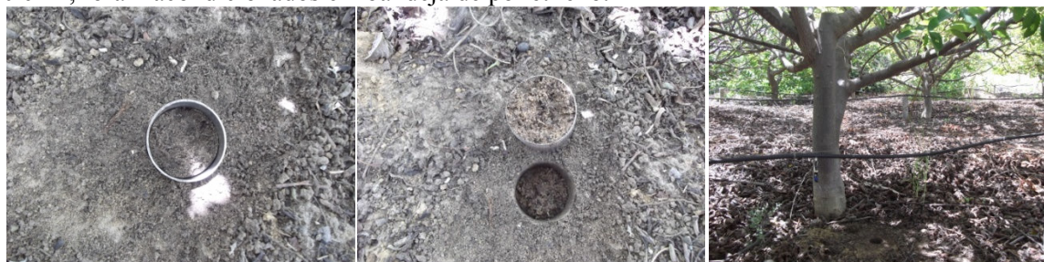
Figura 4 – Coleta de solo para a determinação da umidade do solo.
