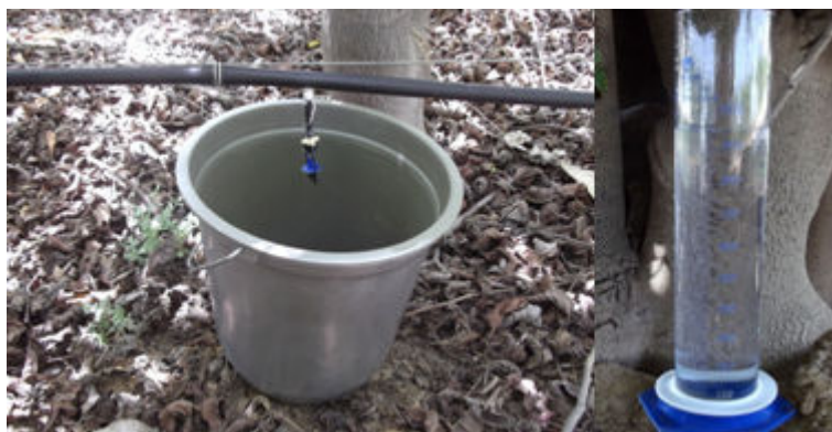
Figura 3 – Demonstração da coleta da água para determinação da vazão dos emissores.
