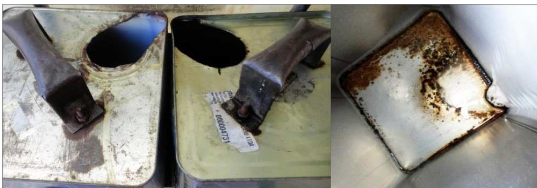
Figura 4 – Latas utilizadas pelos carroceiros na passagem da água armazenada no barril para os vasilhames da população, evidenciando o lado exterior e interior com a presença de ferrugem.
