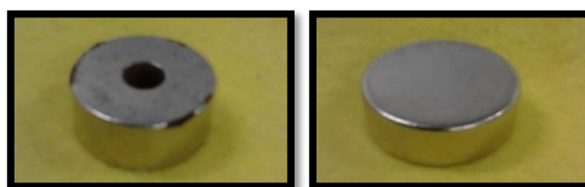
Figura 1 – Ímãs permanentes de neodímio com furo no centro e maciço.
