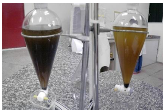
Figura 2 Etapa de separação de fosfatídeos para impedir a formação de sabão.
