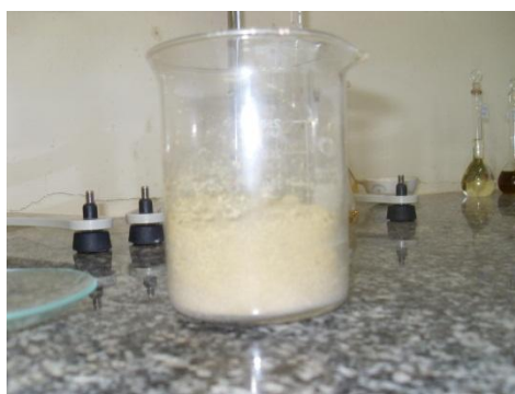
Figura 3 Aspecto visual da terra clarificante e desodorizadora após tratamento
