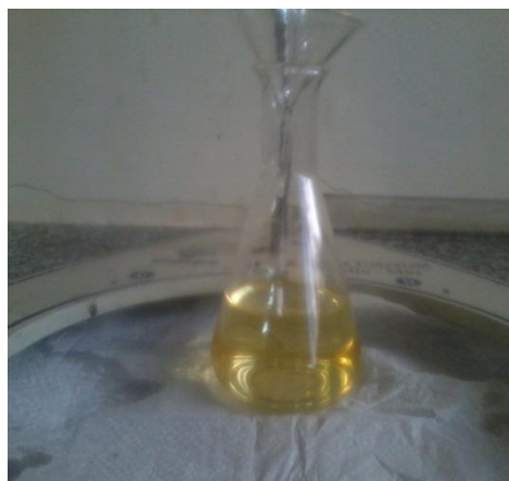
Figura 5 Aspecto visual do óleo de babaçu clarificado e desodorizado com argilominerais
