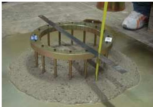
Figura 6- Execução do ensaio Anel J com o traço CAA-04.
