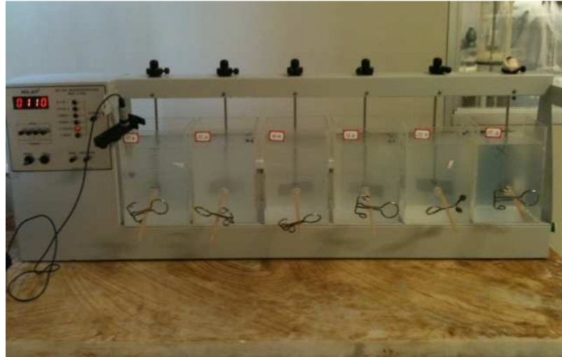
Figura 1 - Equipamento jar test utilizado nos ensaios de mistura rápida-floculação-sedimentação.
