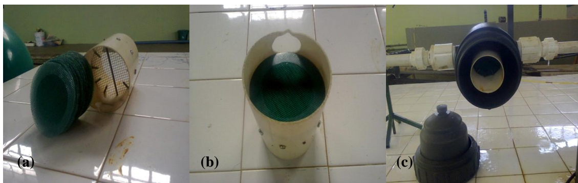
Figura 1 – esquema do filtro artesanal (a), elementos filtrantes colocados no tubo de 100 mm (b) e inseridos no corpo do filtro de disco (c)
