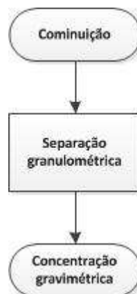
Figura 2 – Fluxograma da moagem da placa
