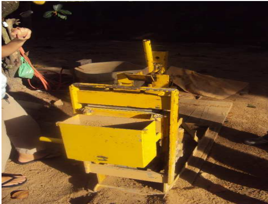
Figura 3. Prensa usada para confecção dos tijolos Fonte: Pesquisa de Campo, 2012
