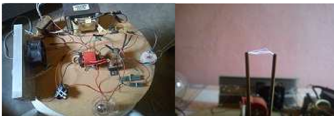
Figura 6 – Retificador/triplificador gerando o arco elétrico
