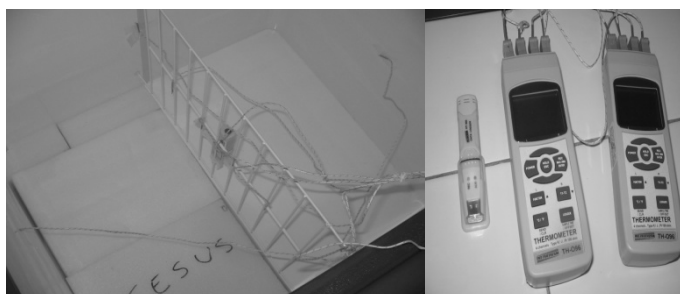
Figura 9 – Montagem para medição de temperatura e umidade relativa dentro do freezer
