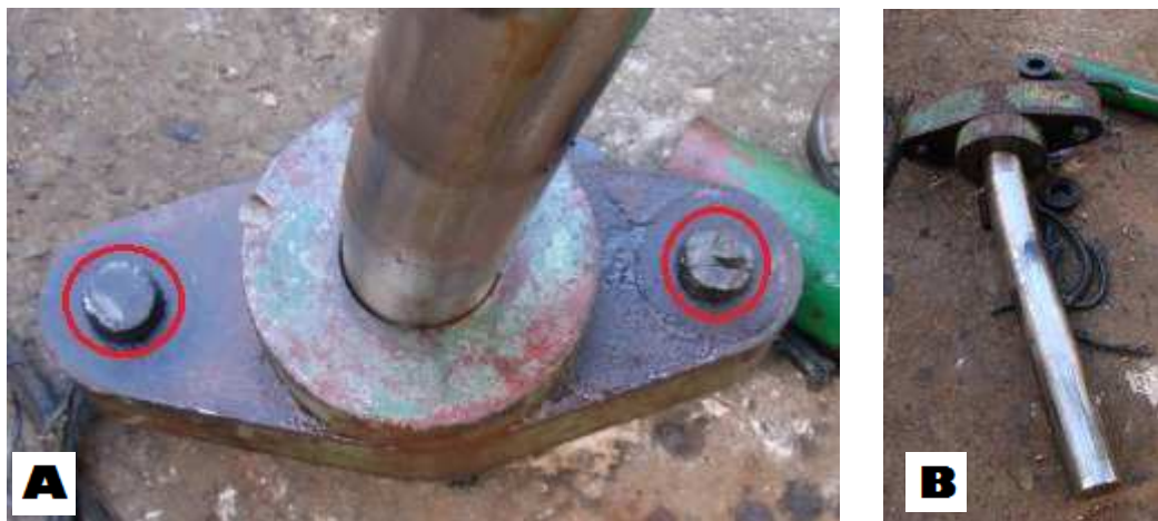
Figura 3 - Êmbolo mostrando o aspecto da falha (A) e a curvatura tomada durante a falha das hastes (B).
