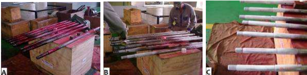
Figura 8: a) Hastes com o líquido penetrante já aplicado. b) Depois da remoção do penetrante o revelador está sendo aplicado. c) Hastes com o revelador já aplicado.
