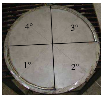
Figura1. Cordão de solda depositado no terceiro quadrante do corpo de prova.
