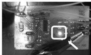
Figura 13 – Led 3 indicando ausência de bateria
