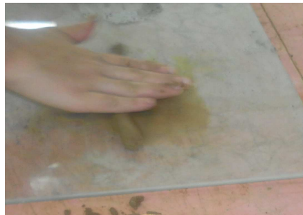
Figura 02 – Ensaio com placa de vidro fosco. Laboratório de Solos do IFAL – Palmeira dos Índios. 2012.
