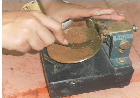
Figura 01 – Ensaio com o aparelho de “Casa Grande”. Laboratório de Solos do IFAL – Palmeira dos Índios. 2012.
