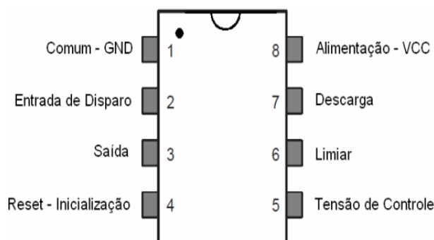
Figura 3 - Mapeamento dos Pinos do CI NE555.
