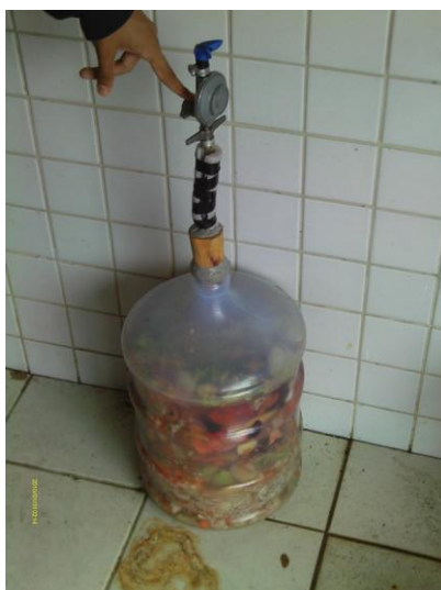
Figura 1 - biodigestor apresentando ausência de biogás devido a falhas na vedação
