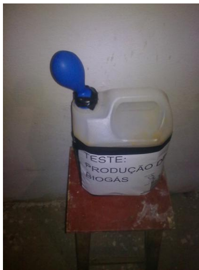
Figura 2 - biodigestor apresentando geração de biogás.
