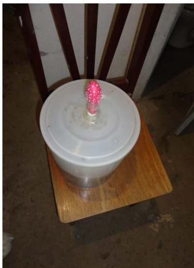
Figura 3 - biodigestor apresentando retardação na produção de gás metano.
