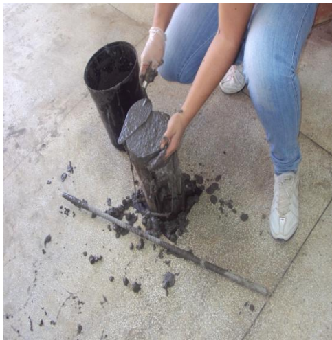
Moldagem dos corpos de prova
