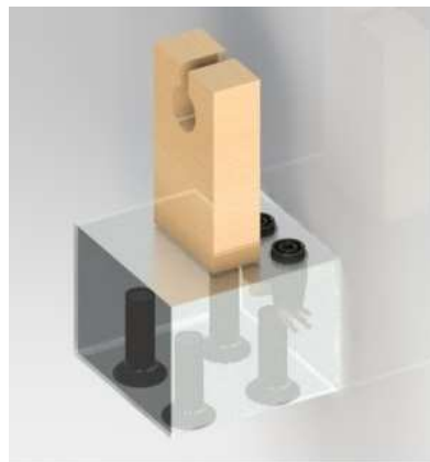
Figura 03 - Projeto da garra eletromagnética
