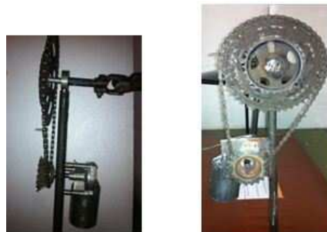
Fig.6: Motor BOSCH e sistema de transmissão: coroa, corrente e pinhão.
