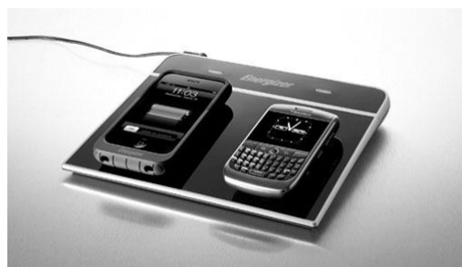
Figura 7 – Celulares colocados num Pad carregador [ENERPW].
