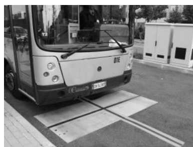
Figura 9 – Modelo de ônibus usado nas cidades italianas de Gênova e Turim. Fazem seu percurso em uma hora e se recarregam em dez minutos (na marca branca no chão) [CWIPT][CWSIT].
