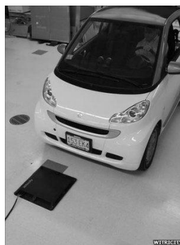
Figura 8 - Carro elétrico da marca Citroën sendo carregado por um dispositivo emissor de campo magnético (no chão) [BBCWC] .
