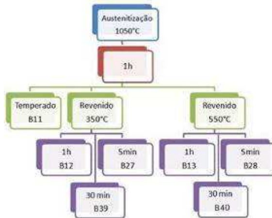
Figura 1c - Fluxograma das amostras austenitizadas por 1h na temperatura de 1050°C, seguidas de têmpera em água. Logo após revenidas a 350°C e 550°C, para de tempos de encharque de 5 min, 30 min e 1h.
