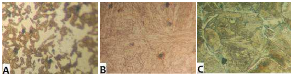
Figura 6 - Apresenta as microestruturas observadas nas amostras austenitizadas por 1h nas temperaturas de 850^{\circ}\text{C} , 950^{\circ}\text{C} e 1050^{\circ}\text{C} e temperadas em água e revenidas a 550^{\circ}\text{C} por 1h. Estruturas completamente recuperadas da: A) perlita fina + martensita revenida; B) estrutura acicular de ferrita e cementita; C) estrutura acicular de ferrita e cementita e contornos de ferrita de Widmanstätten . Aumento 123X.
