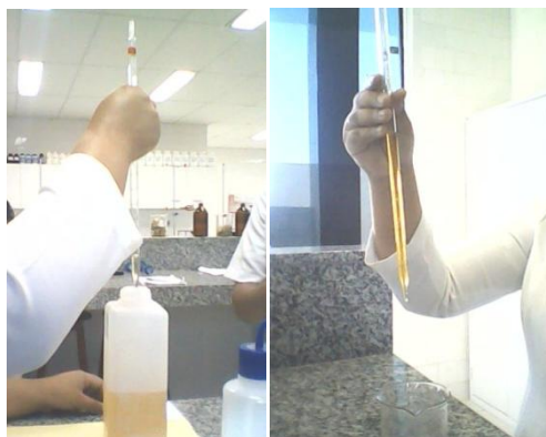
Figura 4 – Medida do tempo de escoamento do biodiesel etílico de fritura, diesel e óleo residual de fritura
