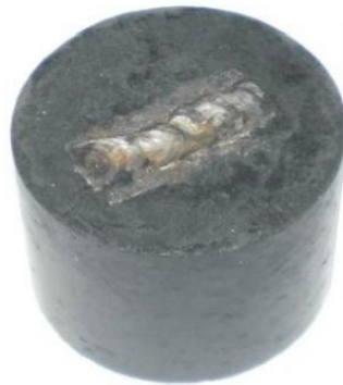
Figura 1 Amostra de solda embutida em baquelite
