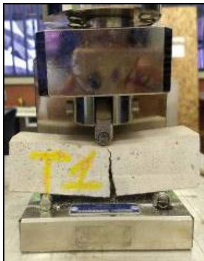
Figura 8 – Ruptura à tração na flexão de corpo de prova prismático.
