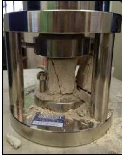
Figura 7 – Ruptura à compressão de corpo de prova prismático.
