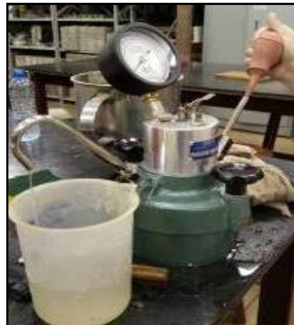
Figura 4 – Equipamento preenchido com argamassa. Figura 5 – Água injetada no aparelho fechado.
