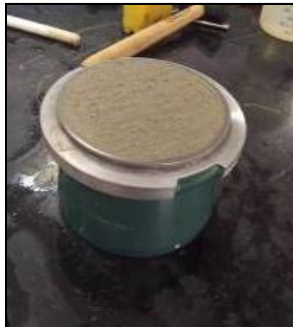
Figura 4 – Equipamento preenchido com argamassa. Figura 5 – Água injetada no aparelho fechado.
