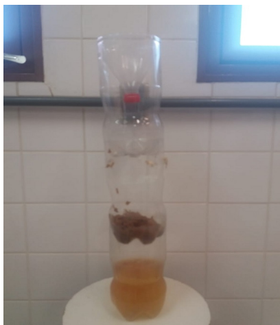
Figura 01. Reator de garrafa PET utilizado para Produzir o fermentado de casca de maçã
