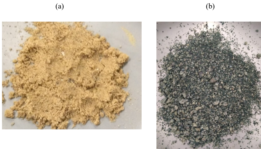
Figura 2: (a) Agregados Convencionais; (b) resíduo de mineração
