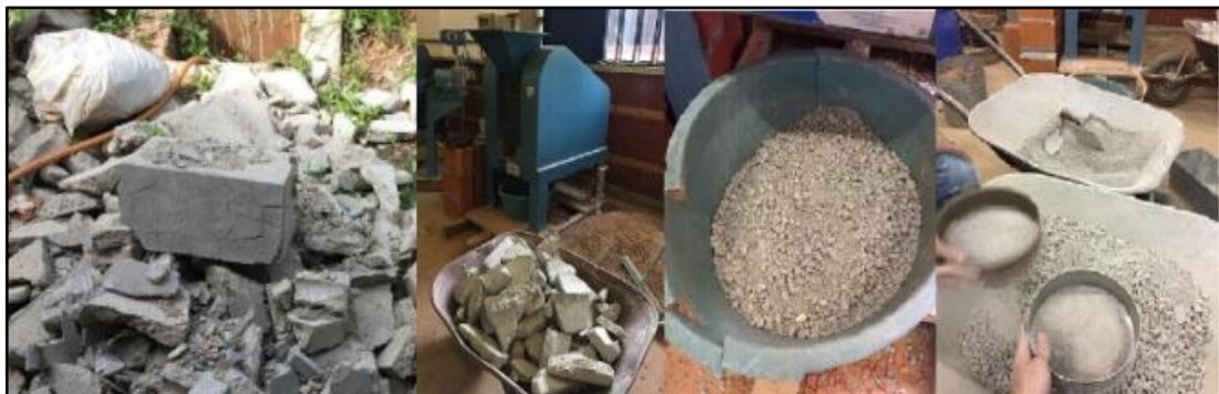
Figura 1 sequência de processamento do resíduo cimentício.
