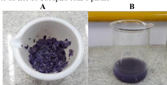
A: Pétalas de Sucupira, maceradas para a formação do extrato. B: Extrato das pétalas de Sucupira filtrado Fonte: Arquivo da pesquisa
