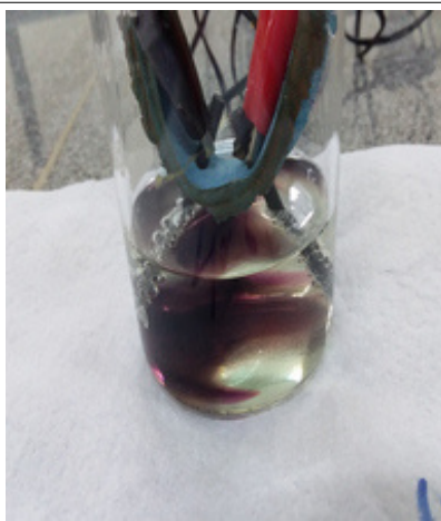
Figura 4 – Degradação do corante com eletrodos de grafite
