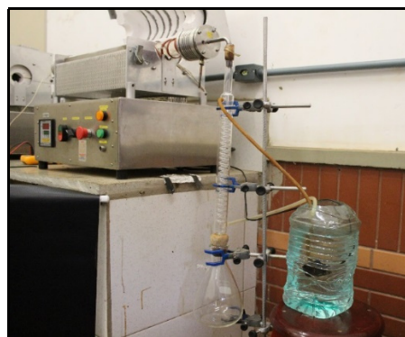
Figura 3 - Sistema de condensação implementado no reator químico de leito fixo.
