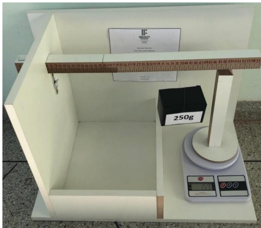
Figura 7 – Modelo Reduzido de Viga Gerber com carregamento
