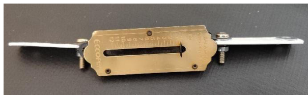
Figura 2 – Balança usada para identificar o esforço de tração
