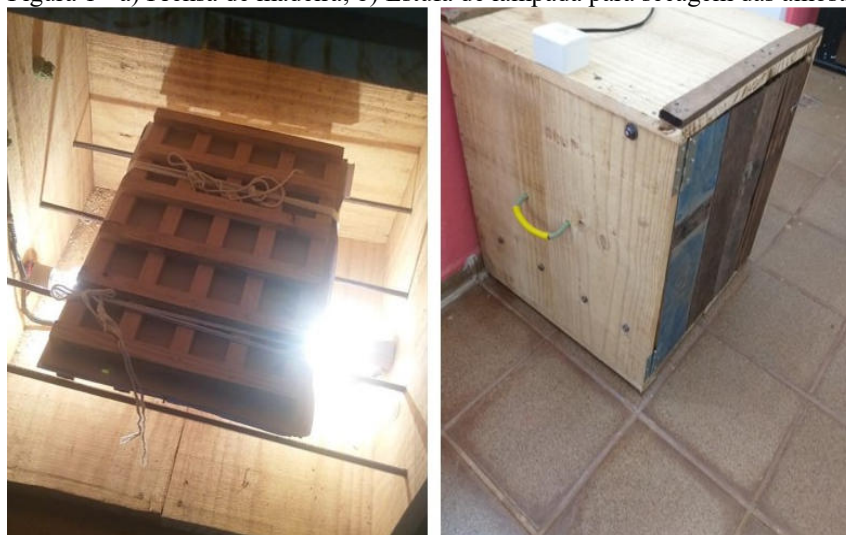
Figura 1 - a) Prensa de madeira; b) Estufa de lâmpada para secagem das amostras.
