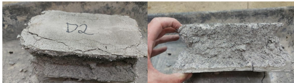
Figura 4 – Corpo de prova após o rompimento
