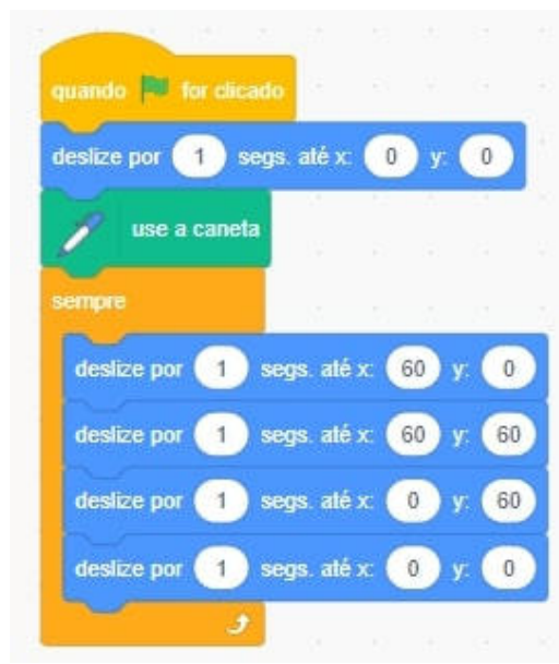
Figura 1- Programa para realizar a trajetória de um quadrado. Fonte própria.
