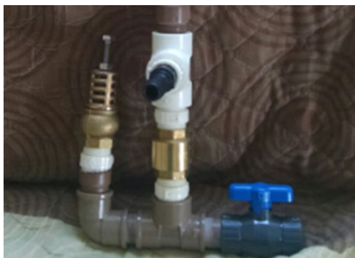
Figura1 - Carneiro Hidráulico montadofoi um de meia polegada, constituído pelo encaixe de peças.
