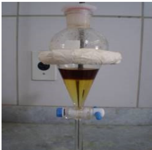
Figura 4 – Separação da fração aquosa do bio-óleo em diclorometano
