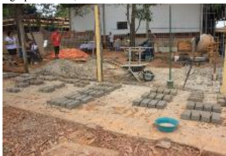
Figura 15: tijolos prontos para secagem e vista para o canteiro de fabricação. Fonte: grupo TEMAS, 2015.
