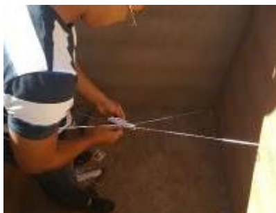
Figura 32: instalação do termômetro no centro do protótipo. Fonte: grupo TEMAS, 2016.
