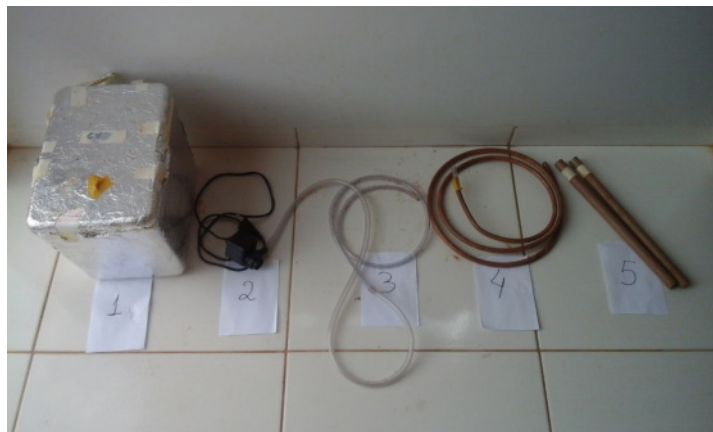
Figura 1. Materiais utilizados na construção da bomba de calor geotérmica. (1) Caixa de isopor recoberta com papel alumínio para reduzir as trocas entre a parte interna da caixa e o meio externo; (2) Bomba de aquário; (3) Mangueira de borracha transparente; (4) Tubo de cobre; (5) Canos PVC 20 mm. Fonte: próprio autor
