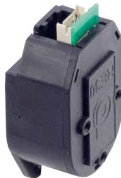
Figura 4 – Sensor Encoder incremental conectado ao motor do Robotino;
