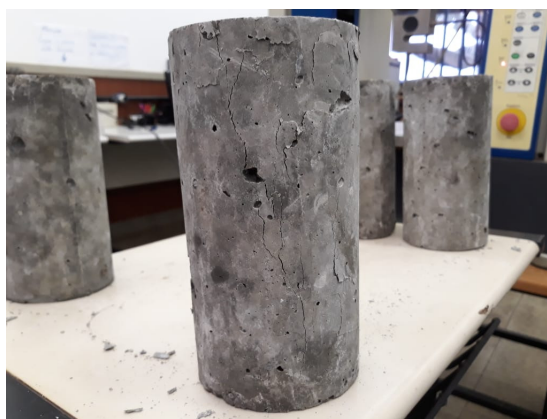
Figura 4 – fissura do corpo de prova após o ensaio de compressão axial.
