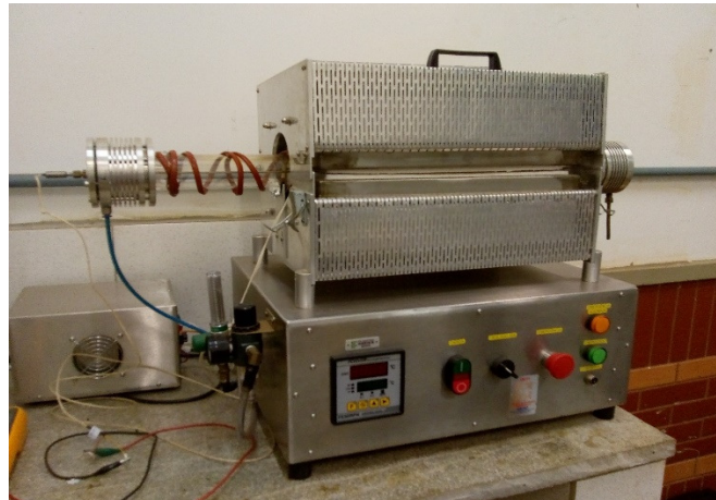
Figura 3.4 – Reator de leito fixo empregado nos experimentos de pirólise de biomassa
