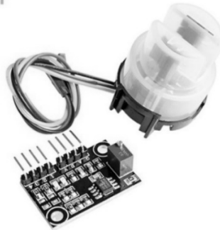
Figura 6: Sensor de Turbidez. Disponível em: https://www.usinainfo.com.br/outros-sensores-arduino/sensor-de-turbidez-arduino-para-monitoramento-da-agua-4539.html . Acessado em: 07 de julho de 2018.
